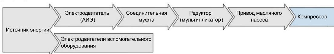
4-х ступенчатая передача энергии центробежного нагнетателя с ЧРП регулированием
