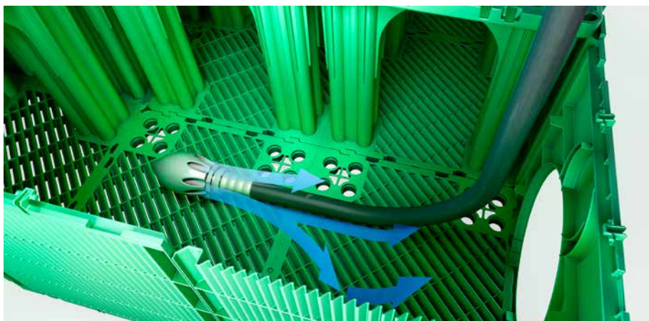
Инновационная особенность боковых панелей и поддонов - ребра жесткости под наклоном, во время прочистки отражают выбрасываемые под напором струи воды, тем самым предотвращая повреждение геотекстиля
