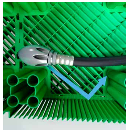
Инновационная особенность боковых панелей и поддонов - ребра жесткости под наклоном, во время прочистки отражают выбрасываемые под напором струи воды, тем самым предотвращая повреждение геотекстиля
